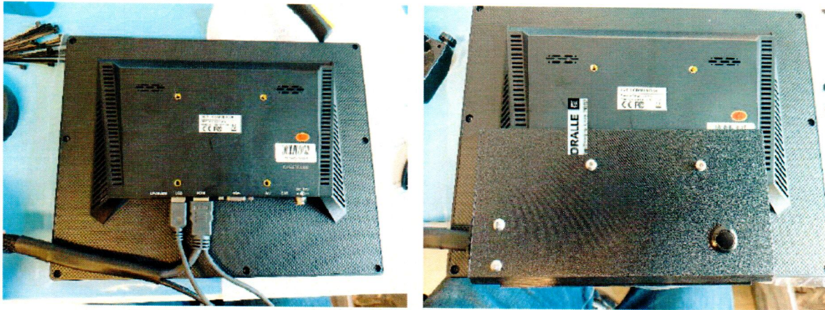
Abbildung 15: Beispiel der Abdeckung und Versiegelung der Display-Schnittstellen ab Rev. 9
