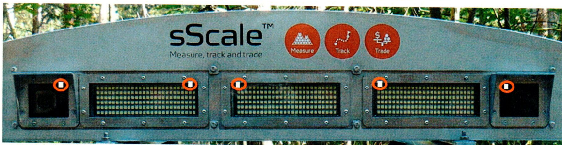
Abbildung 13: Beispiel der Frontansicht der sScale™-Box – montiert im Hangar – mit Position der Sicherungsmarken, die von Innen auf dem Rahmen und der jeweiligen Scheibe aufgebracht sind (in der Darstellung rot eingekreist)
